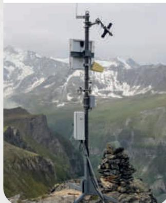
**1** Mesures et suivi en continu (mesures météorologiques, hydrologiques et GPS) sur le glacier rocheux pour **mieux comprendre son fonctionnement** et le **déclenchement des laves torrentielles**.
