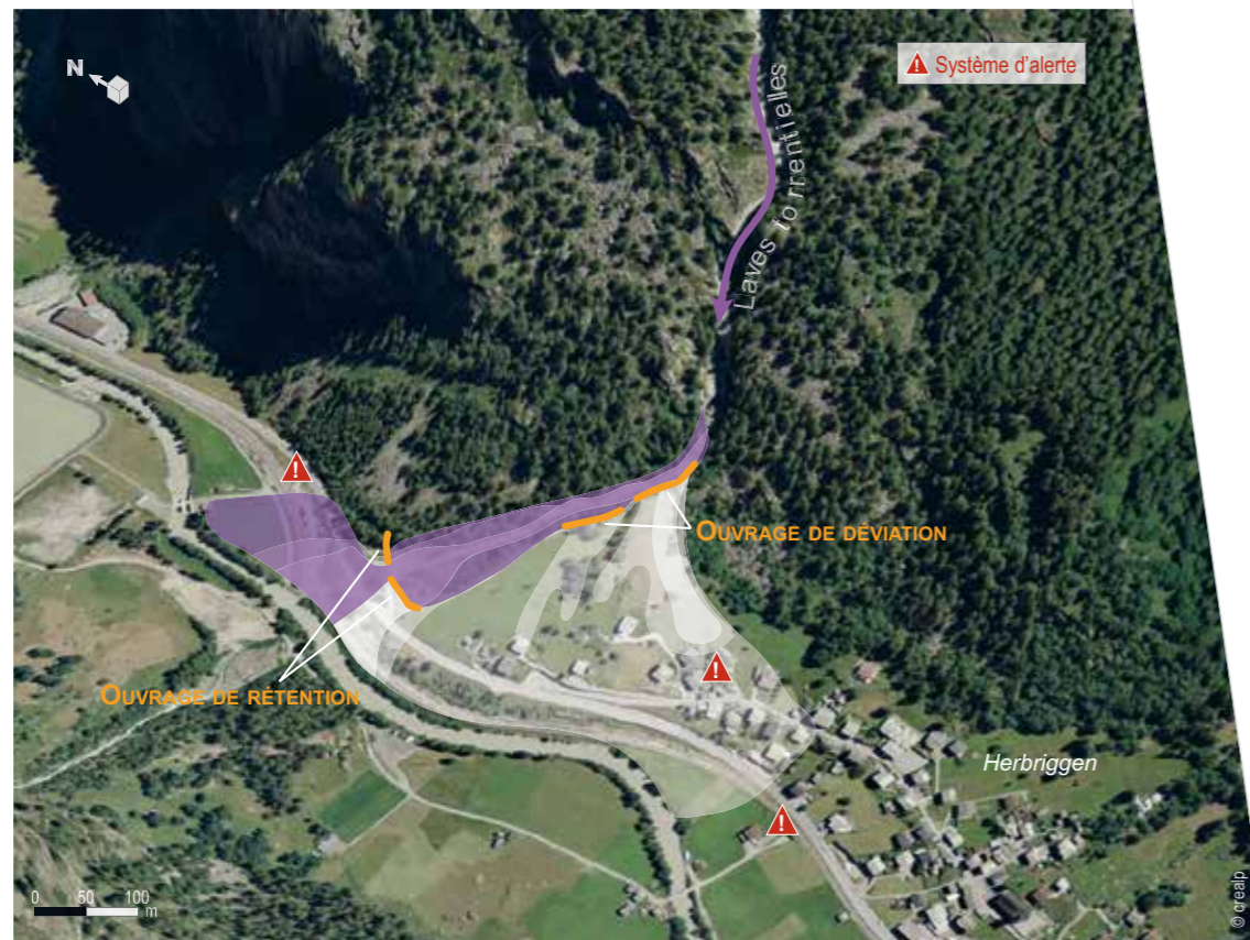
Impact des mesures pour le scénario «300 ans»; en blanc, la zone d'atteinte des laves torrentielles sans mesures de protection; en couleur, la zone d'atteinte après réalisation des mesures
