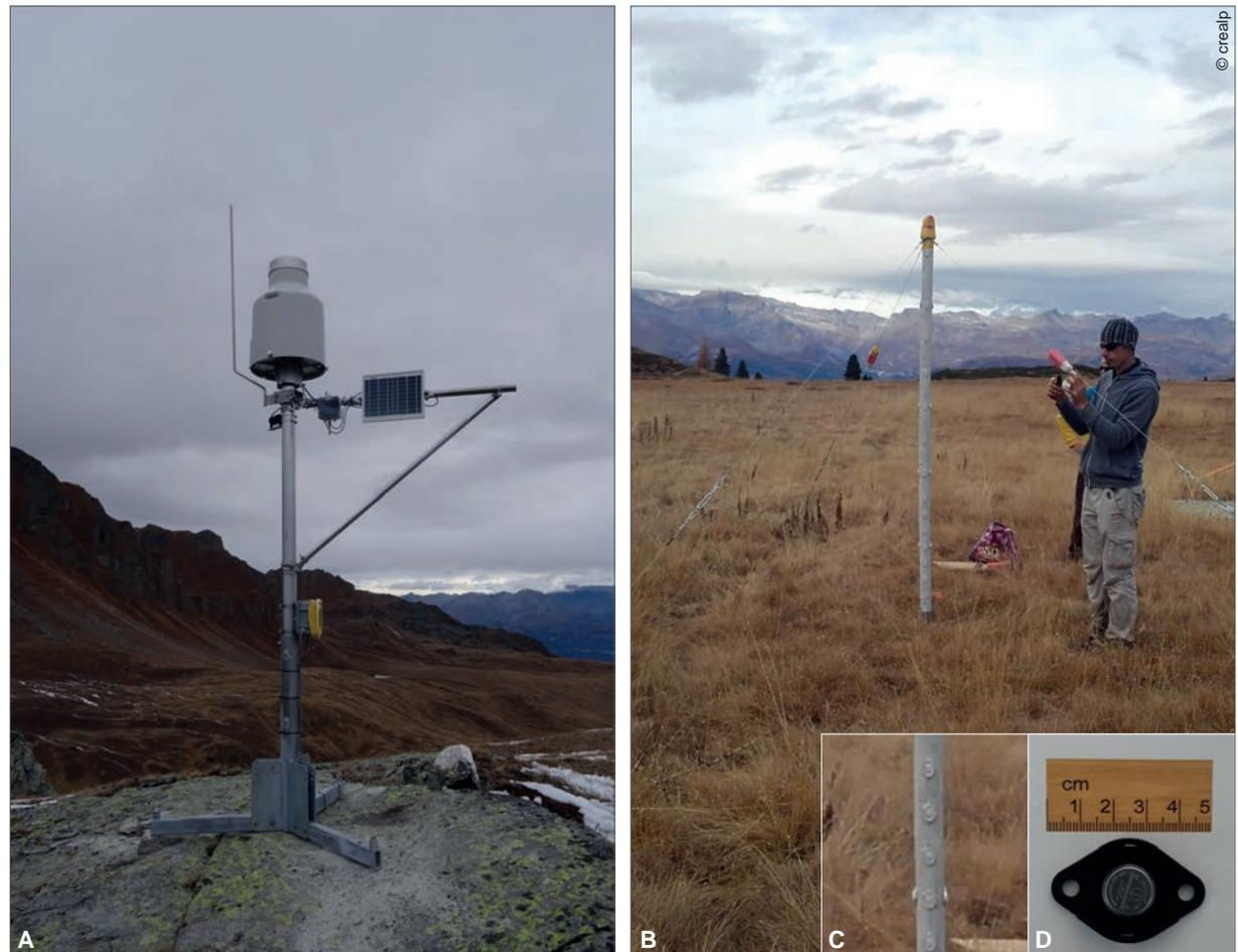
**Projet Réchy : détail des dispositifs de mesure installés dans le vallon de Réchy en octobre 2015. A. Station pluviométrique du Louché (pluviomètre universel à pesée type OTT Pluvio2) ; B. Jalon à neige (Ar du Tsan) ; C. détail d'installation des capteurs-boutons sur le mât ; D. capteur-bouton et support d'installation.**
