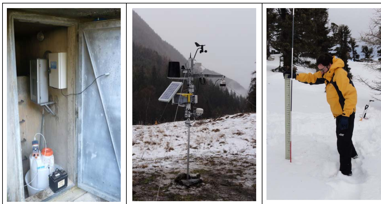
Figure 12 : Projet STRADA - gestion des sources de Montagne : Source de la Lé, (Vallon de Réchy VS). De gauche à droite : Station hydrométrique, station météorologique, mesures nivométriques
