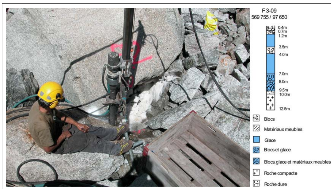
Figure 7 : Glacier noir des Liapeys de Grône – exécution d'un des 4 forages MFT avec son log géologique [© CREALP 2009]
